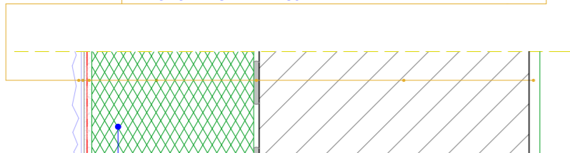
STYROPIAN 50X50CM SWISSPOR WHITE FASADA \lambda_D = 0,031 [W/mK] 15 25 ISTNIEJĄCA ŚCIANA MUROWANA Z PROJEKTOWANYM DOCIEPLENIEM WYMIENIANYM W CAŁOŚCI NA ŚCIANACH SZCZYTOWYCH
